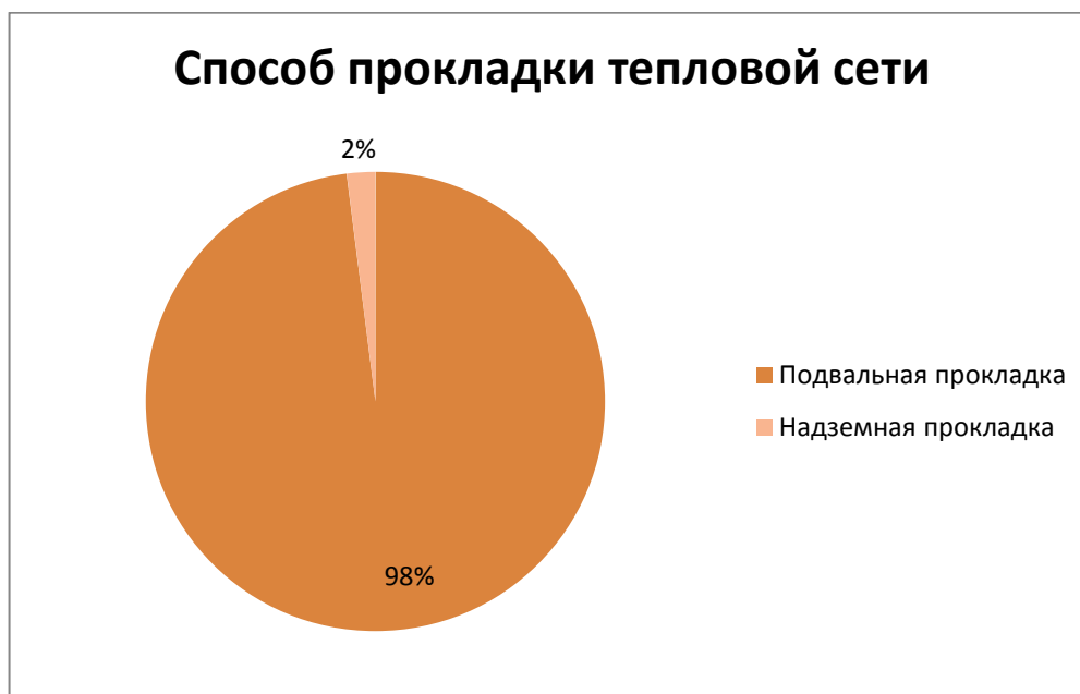
Рисунок 1.7 – Распределение тепловых сетей котельной с. Кочневка по способу прокладки
